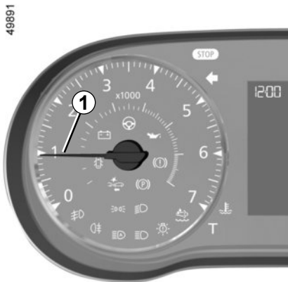
Käyntinopeusmittari 1 (r/min x 1000)
