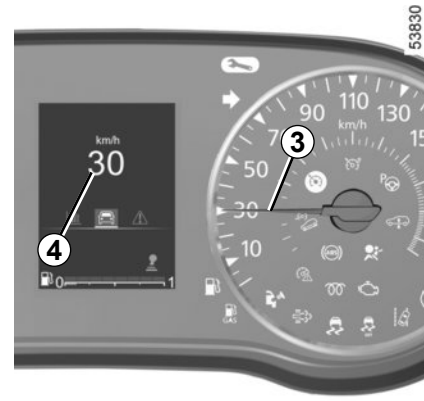
Nopeusmittarit 3 ja kattoluukku (automallin mukaan), 4 (km tai mailia tunnissa)
